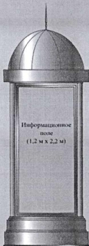
**Афишная тумба** - типовая отдельно стоящая рекламная конструкция с внутренним подсветом, состоящая из фундамента, каркаса и информационного поля.
